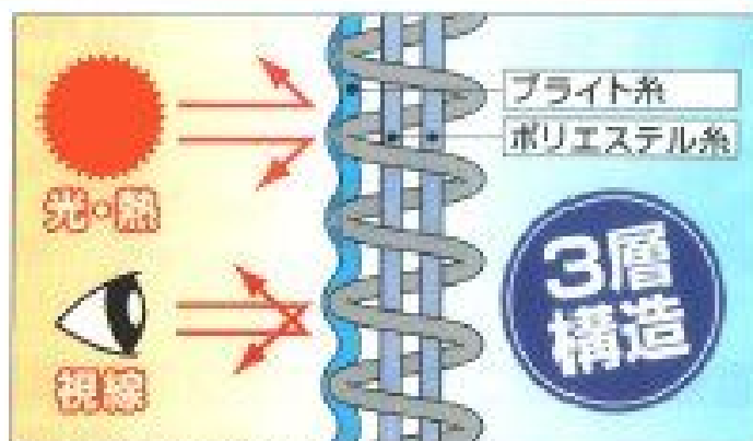
参考：3層構造の編み物遮熱カーテンの断面図
